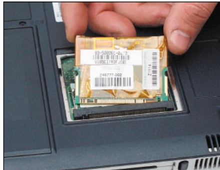
Modem estraibile. Alcuni notebook hanno a disposizione una porta, denominata Mini PCI, su cui si possono collegare modem o scheda di rete. Il collegamento è molto simile a quello delle memorie di sistema.
