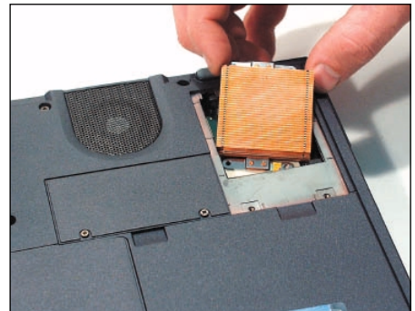
Collegare il dissipatore. Il dissipatore, o ventola, è indispensabile nei processori di ultima generazione. È importante ricordarsi di applicare un piccolo velo di pasta siliconica tra la CPU e il dissipatore stesso.
