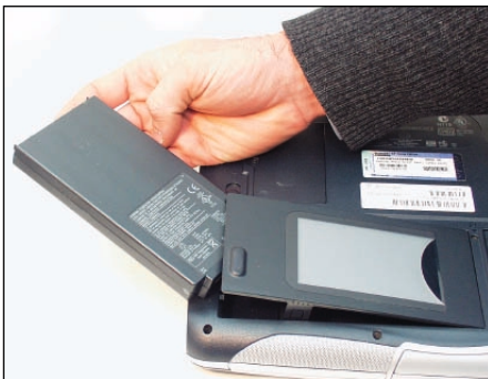
La batteria. Questo componente è forse il più importante per un portatile. Prima dell'acquisto verificare che sia un modello agli ioni di litio.
