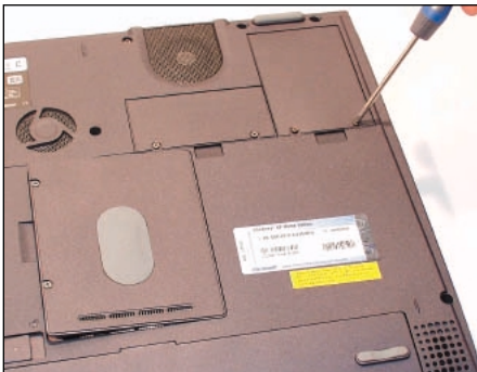
Aprire gli sportellini. Tutti i componenti estraibili sono facilmente raggiungibili svitando le viti degli sportellini nella parte posteriore del notebook. In alcuni casi l'inserimento dei banchi di memoria viene effettuato sollevando la tastiera.
