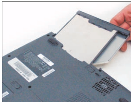
Lettori multimediali. Nella stessa bay si può alloggiare un DVD, un Combo, un masterizzatore ed anche una batteria aggiuntiva. Per rimuovere il componente basta sbloccare il fermo posto sotto il portatile ed estrarre il lettore.
