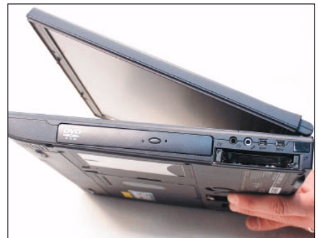
Porte PCMCIA. Il collegamento con componenti esterni può avvenire tramite porta USB, Firewire e PCMCIA. Conviene averle tutte a disposizione, possibilmente due per tipo.
