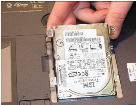
Collegare l'unità disco. Nella scelta del notebook ideale è importante preferire un modello con hard disk estraibile. Il collegamento avviene direttamente sul controller Eide senza la necessità di cavi aggiuntivi.
